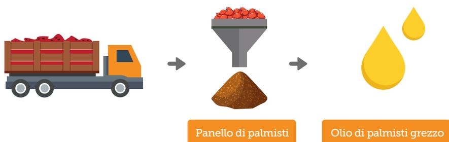
I noccioli di palma sono trasportati in strutture di frantumazione separate. Il nocciolo viene frantumato e rimosso dal suo guscio che viene utilizzato come combustibile da biomassa.
