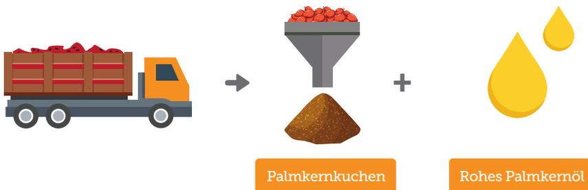
Palmkerne werden zu Palmkerncrushern transportiert. Der Kern wird geknackt und von der Schale getrennt, die als biogener Brennstoff dient. Der Kern wird gepresst, um Palmkernöl (PKO) und Palmkernkuchen (PKE) herzustellen.
