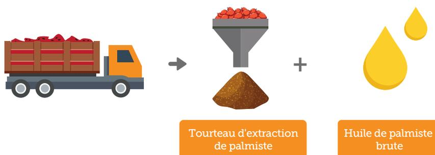
Les noyaux des fruits du palmier à huile sont transportés vers des installations de broyage séparées. Le noyau est ouvert et l'amande est retirée de la coque de palme qui est ensuite utilisée comme combustible de biomasse. L'amande est pressée pour produire de l'huile de palmiste (PKO - Palm Kernel Oil) et du tourteau de pression de palmiste (PKE - Palm Kernel Expeller).
