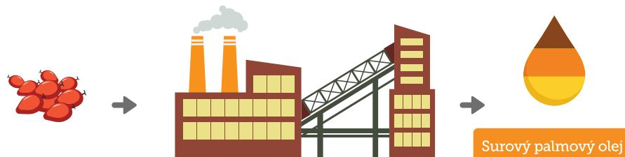
Čerstvé svazky plodů (FFB) z velkých plantáží, od obchodníků a drobných zemědělců jsou dovezeny do zpracovatelského závodu. FFB jsou sterilizovány a oloupány. Plody lisují, aby se oddělil olej od jádra. Olej je vyčištěn a odkalen.
