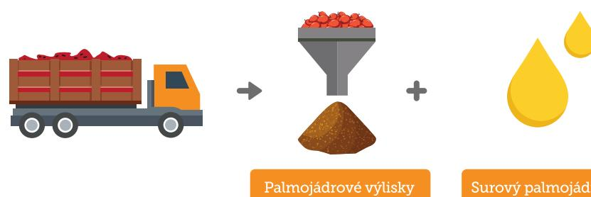
Palmová jádra jsou převážena do oddělených drtících zařízení. Jádro se rozlouskne a vymíje ze skorápk, která se využívá na biomasové palivo. Rozdracením jádra pak vzniká palmojádrový olej (PKO) a palmojádrové výlisky (PKE).
