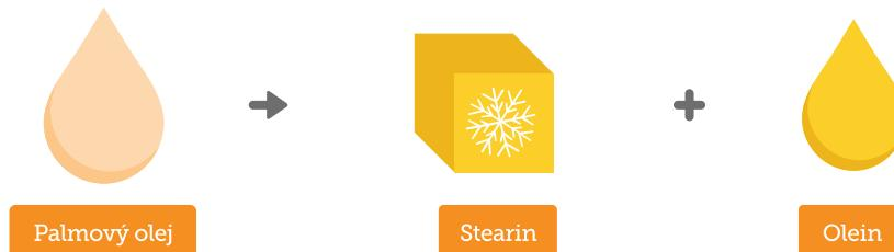
**Frakcionace** - představuje proces dělení na části neboli frakce. Tento proces lze opakovat pro vytvoření různých frakcí z jedné suroviny. Proces frakcionace palmového a palmojádrového oleje má obvykle šest různých úrovní. Je však možné pokračovat ve frakční destilaci do dalších úrovní k dosažení jiných účelů. Frakcionace dosahнемe ochlazením oleje za řízených podmínek (krytalizace) a následnou filtrace. Stručně řečeno, kapalný palmový olein je oddělen od pevného stearinu.
