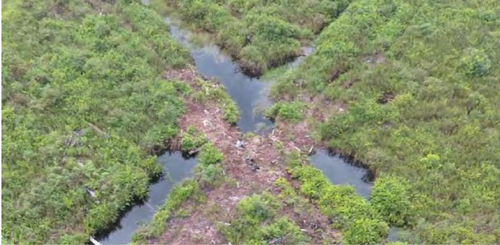
*Gambar 3-12b (bawah): Kanal berukuran sedang di kawasan konservasi di Kalimantan Barat disekat dengan bendungan dari gambut yang dipadatkan menggunakan ekskavator.*
