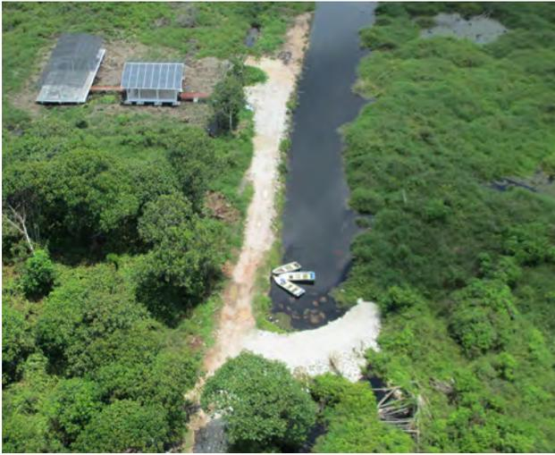
Gambar 3-18b: Bendungan yang sama yang terbuat dari pecahan batu pada tahun 2014, setahun pasca pembangunan.
