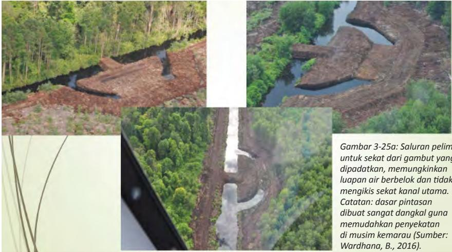
Gambar 3-25a: Saluran pelimpah untuk sekat dari gambut yang dipadatkan, memungkinkan luapan air berbelok dan tidak mengikis sekat kanal utama. Catatan: dasar pintasan dibuat sangat dangkal guna memudahkan penyekatan di musim kemarau (Sumber: Wardhana, B., 2016).
