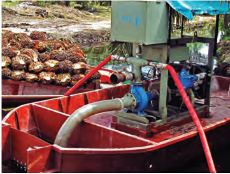
Gambar A5-1: Contoh ambilan jarak dekat (close up) kapal pemadam kebakaran yang digunakan untuk kegiatan penanggulangan kebakaran di perkebunan sawit pada lahan gambut.
