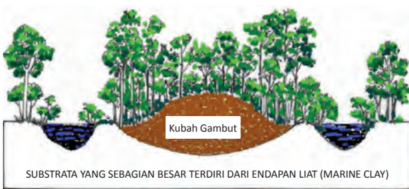
Gambar 2-3: Diagram skematik lahan gambut berkubah (Ombrogen) (Sumber: M. J. Silvius, Wetlands Internasional)
