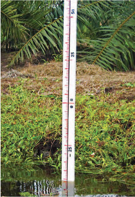
Gambar 7-5: Pengukuran untuk memantau tinggi muka air di saluran kolektor.
