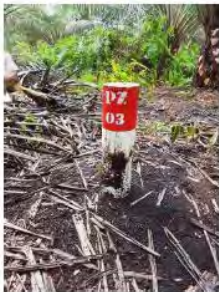
Gambar 7-5: Pengukuran untuk memantau tinggi muka air di saluran kolektor.
