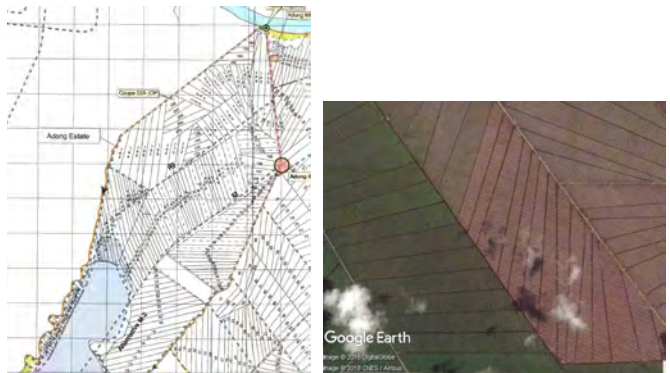
Gambar 3-12: Tata letak drainase estate Adong di Perkebunan Woodman, Miri, Sarawak (peta di bagian kiri dan citra satelit di bagian kanan). Rancangan sistem drainase tersebut mengacu pada kontur saluran kolektor yang mengalir sepanjang garis kontur dari sudut lancip hingga ke saluran utama atau saluran pengeluar.
