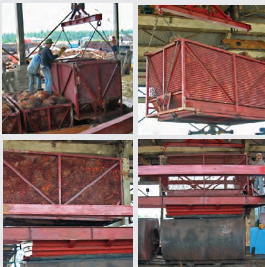
Gambar 5-4: Serangkaian foto yang menunjukkan sistem transportasi TBS yang baru. Dari bagian kiri atas: TBS dalam lori diangkat dari ponton, lori dipindahkan dan diletakkan di atas ketel uap dan TBS dimasukkan ke dalam ketel tersebut.
