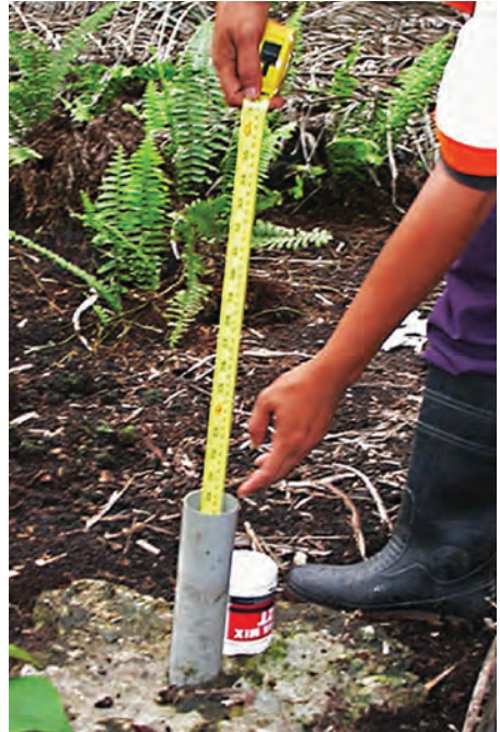
Gambar 7-6: Contoh alat piezometer untuk mengukur tinggi muka air tanah
