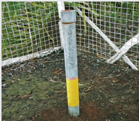
Gambar 7-2: Foto tiang subsidiensi di tahun 2010. Tiang ini telah dipasang sejak akhir tahun 2007, yakni 10 tahun setelah drainase awal.
