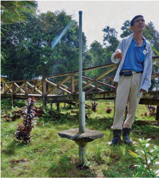
Gambar 7-1: Contoh tiang subsidiensi yang dipasang bersama piezometer [Foto tiang yang sama; sebelah kiri diambil pada 2011 dan sebelah kanan diambil pada 2018]. Terlihat jelas perubahan subsidiensi lahan gambut sepanjang waktu.
