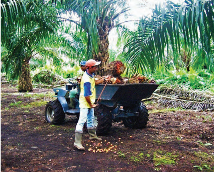
Gambar 5-8: Roda LGP di jalur dipadatkan
