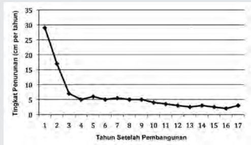
Gambar 2-5: Perkembangan subsidensi gambut yang dikeringkan pada budidaya sawit di Stasiun Penelitian MPOB, Sessang, Sarawak.
