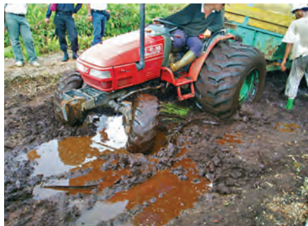
Gambar 5-5: Permasalahan operasional yang ditemui saat daya dukung tanah di lahan gambut yang dalam terlampaui.
