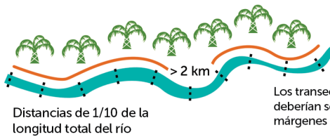
Figura 5. Cómo medir el ancho del río y los sitios de muestreo para ríos de diferentes longitudes.
