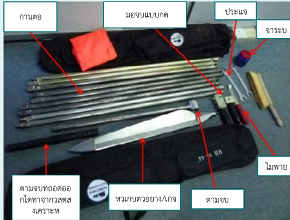
รูปที่ 2: ส่วนเจาะพรุและวิธีการใช้หัวส่วนนี้ (ที่มา: Global Environment Centre, GEC)
