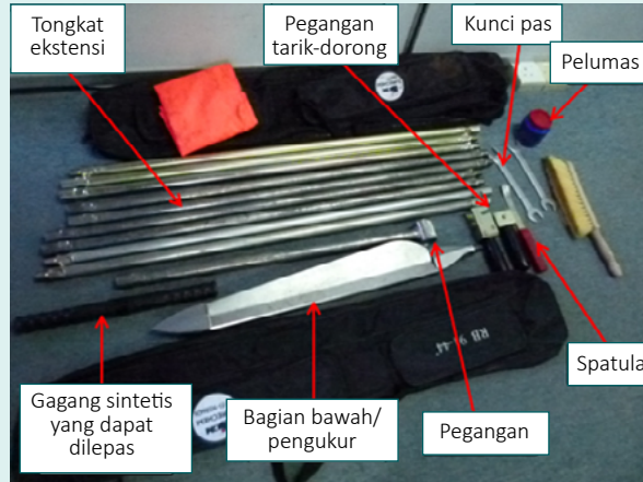
Gambar 2: Alat bor gambut dan metode untuk menggunakan bor ini (Sumber gambar: Global Environment Centre/GEC)
